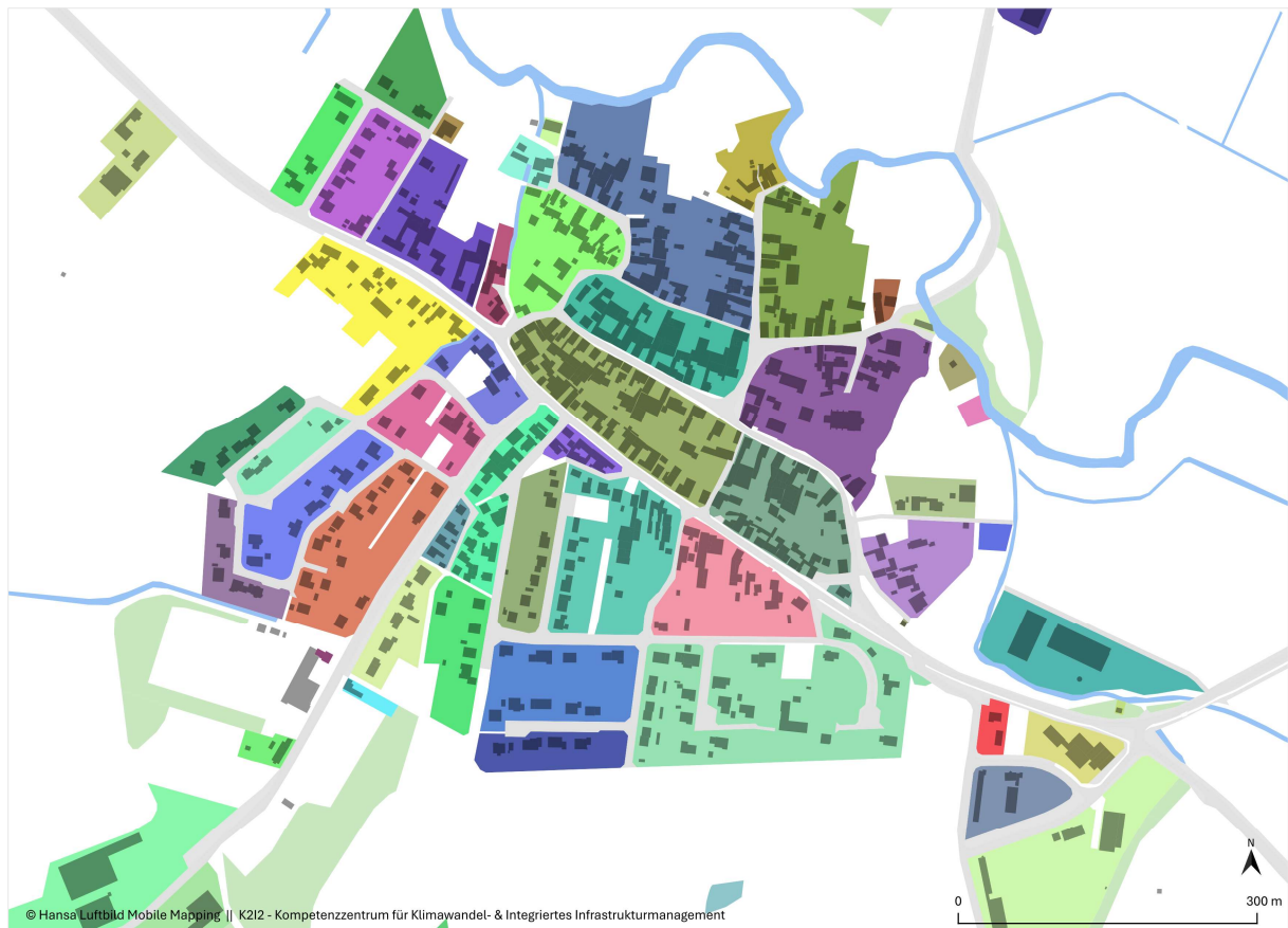
Abb. 5: Der Baublock als maßgebliche Analyse- und Planungsebene für die kommunale Wärmeplanung (am Beispiel von Rüdershausen)
