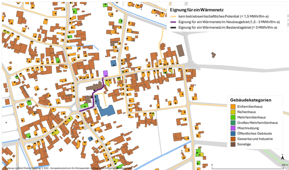
Abb. 11: Wärmelinien-dichte Megawattstunden pro laufendem Meter und Jahr (MWh/lfm-a) und deren Eignung für ein Wärmenetz (Obernfeld)
