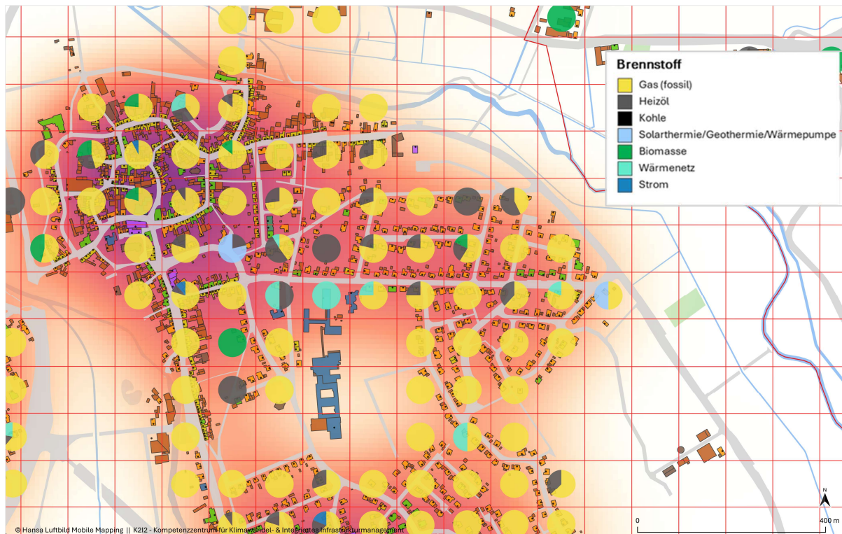
Abb. 10: Ermittelte räumliche Brennstoffverteilung, dargestellt auf dem 100x100-Meter-Zensusgitter (Flecken Gieboldehausen)
